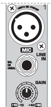
Fig. 2.1: Connettori e manopole degli ingressi Mic/Line
