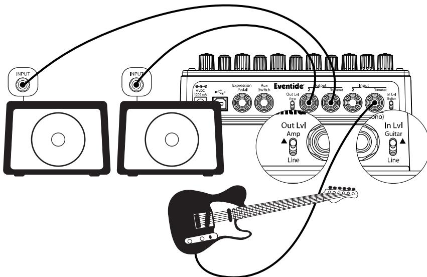
Inserire il cavo della chitarra nell'ingresso 1 di PitchFactor e collegare un cavo dall'uscita 1 di PitchFactor ad un amplificatore e un secondo cavo dall'uscita 2 di PitchFactor all'altro amplificatore; spostare il selettore del livello d'ingresso (**In Lvl**) in **GUITAR** e quello del livello d'uscita (**Out Lvl**) in **AMP**.
