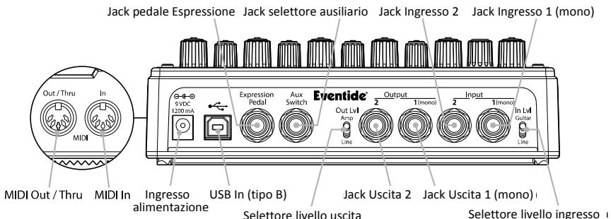
PitchFactor si può collegare direttamente alla chitarra, dopo un altro pedale, nel loop effetti dell'amplificatore o ai jack Send/Return o Insert del mixer. Data la varietà di chitarre, pedali effetti, amplificatori e mixer è impossibile indicare un setup "ideale". Il setup deve essere scelto dall'utente in base al suono desiderato.
