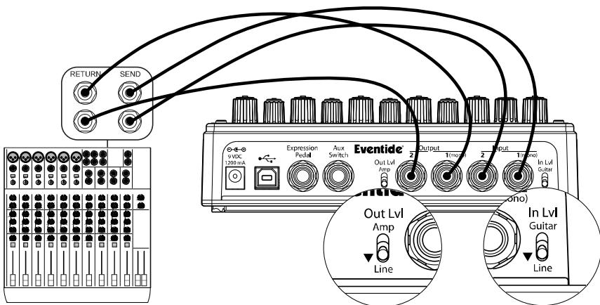
Se si collega PitchFactor a un Mixer spostare i selettori del livello d'ingresso e uscita di PitchFactor in **Line**.
